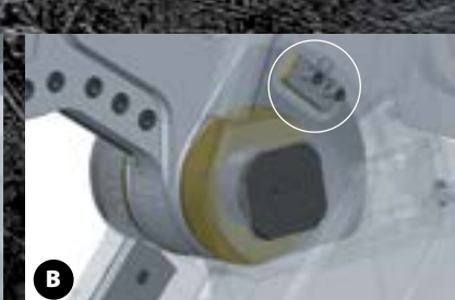
A DRS 25-45 Système de Guidage de la Mâchoire mobile Unique, extrêmement robuste (SGS) – facile à entretenir
